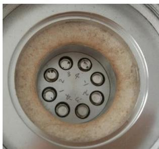
图 6: BM4 / OM4 系列差示扫描量热仪炉体
